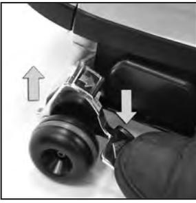
**8** Drücken Sie das Bodenpedal der Fußbedienung ganz nach unten, um den vorderen Teil der Einheit anzuheben.
