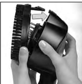
**3** Setzen Sie die Turbine in den Aufsatz zurück und drehen Sie sie, bis die Nasen in die Aussparungen fallen. Lassen Sie den Bürstenring wieder einrasten.
