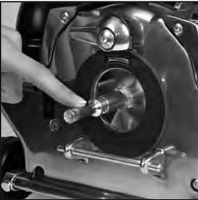
Halten Sie die Motorwelle frei von Flusen, Haaren und Schmutzablagerungen.
