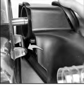
**9** Verbinden Sie die Haken an der Rückseite des Shampooiersystems mit der Anschlussstange.
